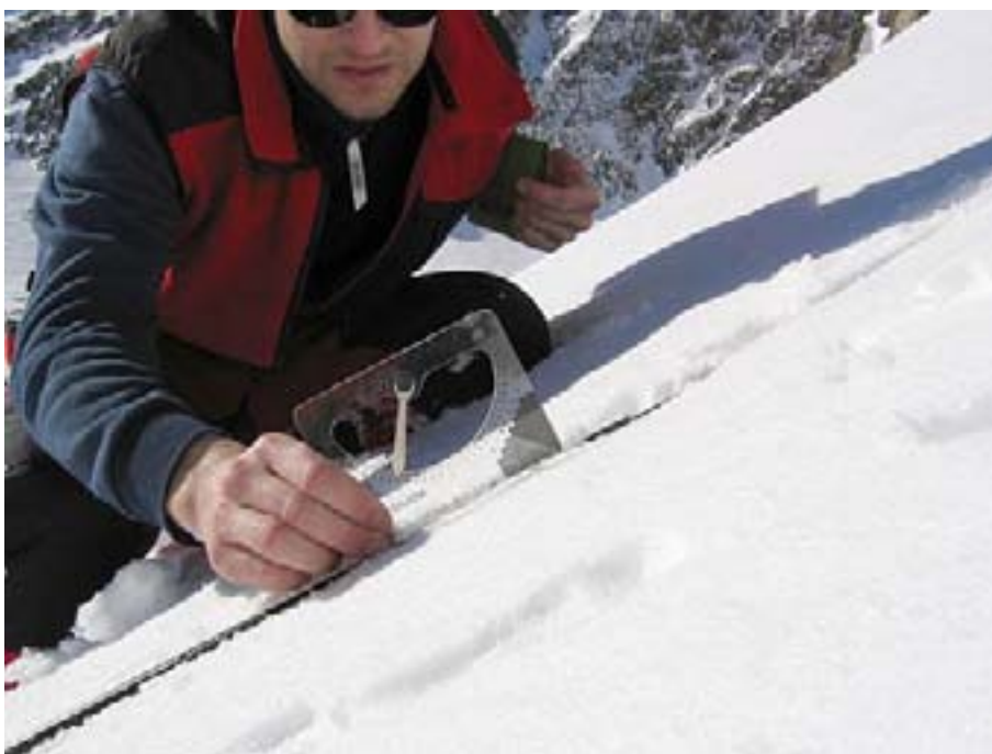
Obrázek 4: Měření sklonu pomocí sklonoměru
